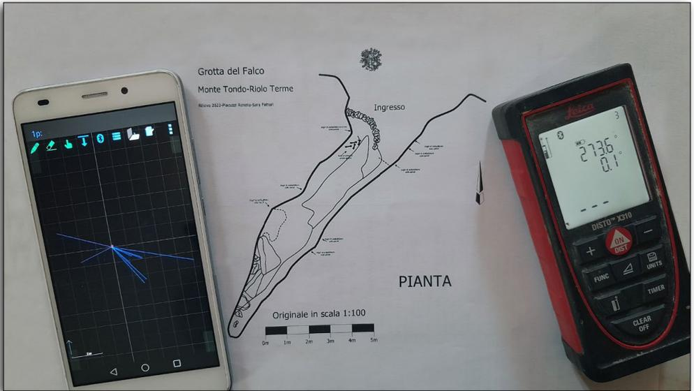
Appena inviati, il programma è in grado già di visualizzare tutte le tratte misurate e di vedere in tempo reale sia la pianta che la sezione della nostra cavità.
