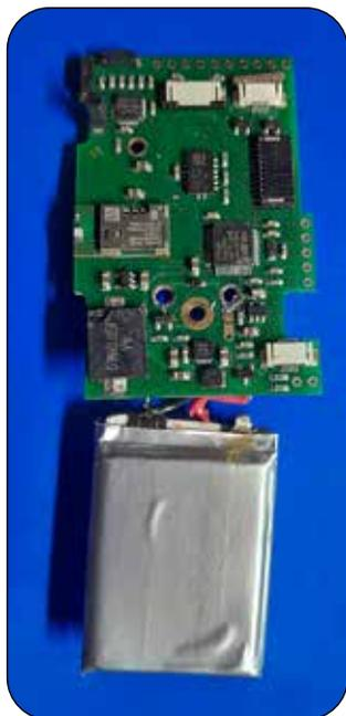
Un appassionato Svizzero di speleologia e di elettronica ha ricostruito la scheda di questo apparecchio implementandola di bussola e clinometro in modo che con un solo clic si ottengono i dati che a noi interessano:
